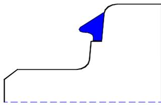
3. **DS SG** Vordehnung durch Ziehen an einigen Stellen ausgleichen, damit rundum der gleiche Dichtungsquerschnitt vorhanden ist.
